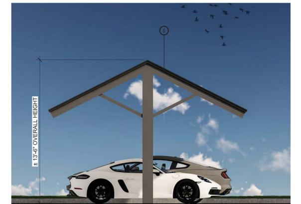
1 EXTERIOR ELEVATION CARPORT - SIDE ELEVATION
