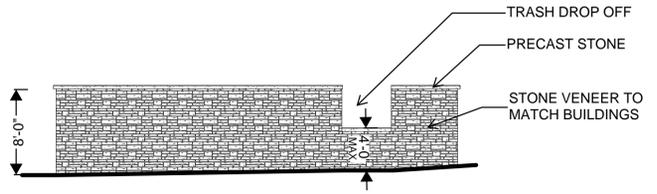
**8 TRASH ENCLOSURE - EAST ELEVATION**
