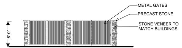
**6 TRASH ENCLOSURE - FRONT ELEVATION**
